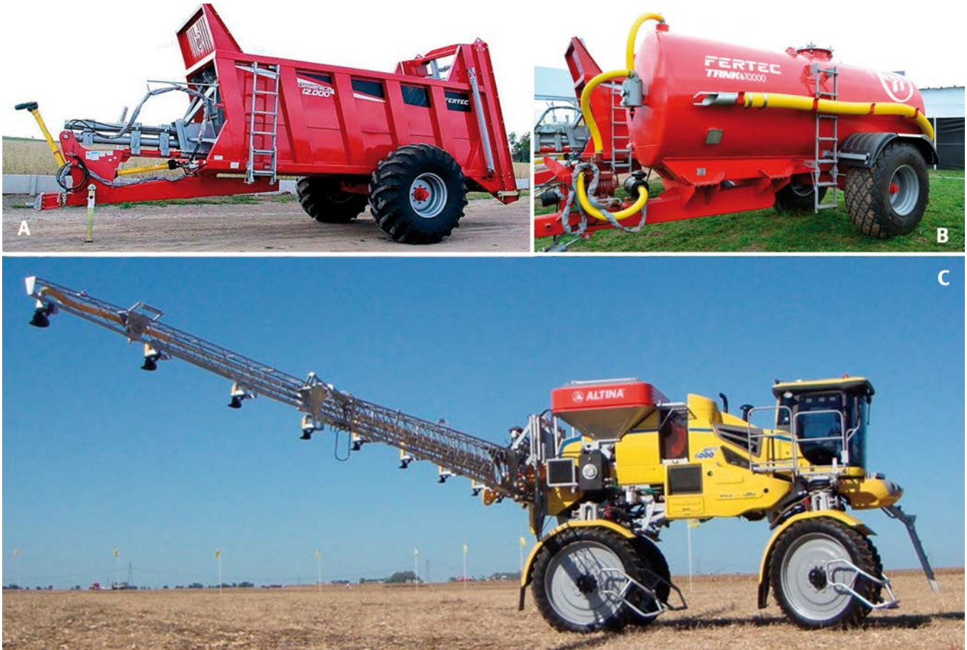
Fertilizadoras: a) y b) Tanques para fertilizantes líquidos y estercoleras Fertec, respectivamente. c) Fertilizadora neumática autopropulsada Pla-Altina.
