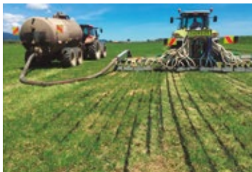
Inyectora de arrastre conectada a un tanque purinero
