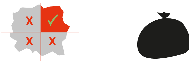
Figura 5.10 Cuarteo de la muestra de suelo y presentación final de la muestra.
