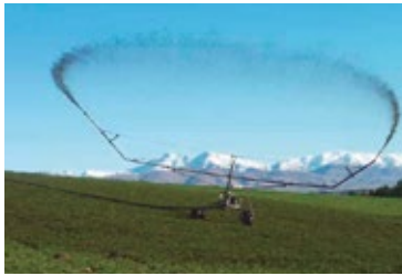
Regador móvil conectado a la fuente de purín por manguera
