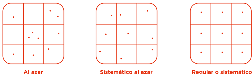
Figura 5.9 Diferentes esquemas en los que podemos basarnos para seleccionar los puntos de muestreo de suelo.
