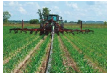
Incorporación directa de arrastre conectada por manguera a la fuente de purín
