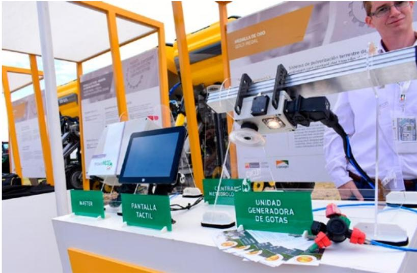
Tecnopulverización. Sistema de pulverización de ultrabajo volumen con control de gotas de tamaño variable
