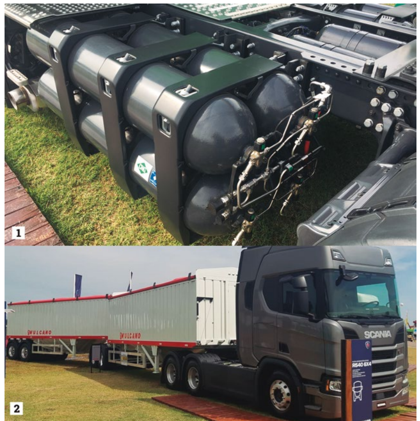
Scania. 1) Detalle tanques GNC línea de motores Scania Green Efficiency. 2) Bitrenes Vulcano.
