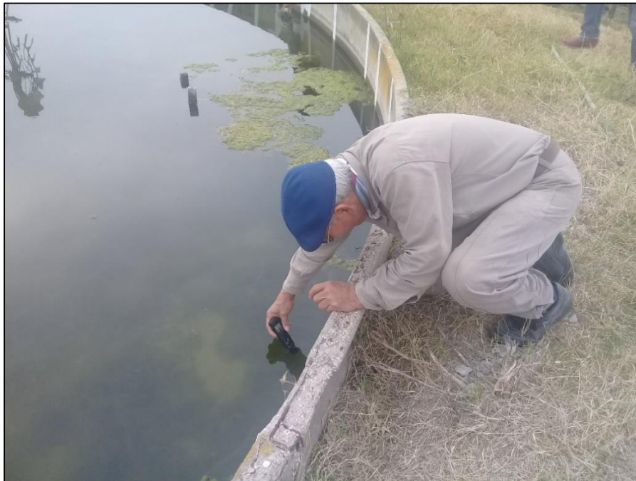
Aroldo midiendo la conductividad eléctrica del agua almacenada en el tanque.
