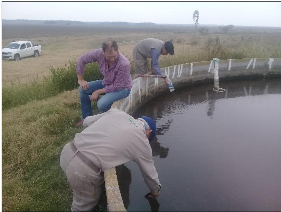
Aroldo midiendo la conductividad eléctrica del agua y Matías tomando una muestra de agua para ser analizada.
